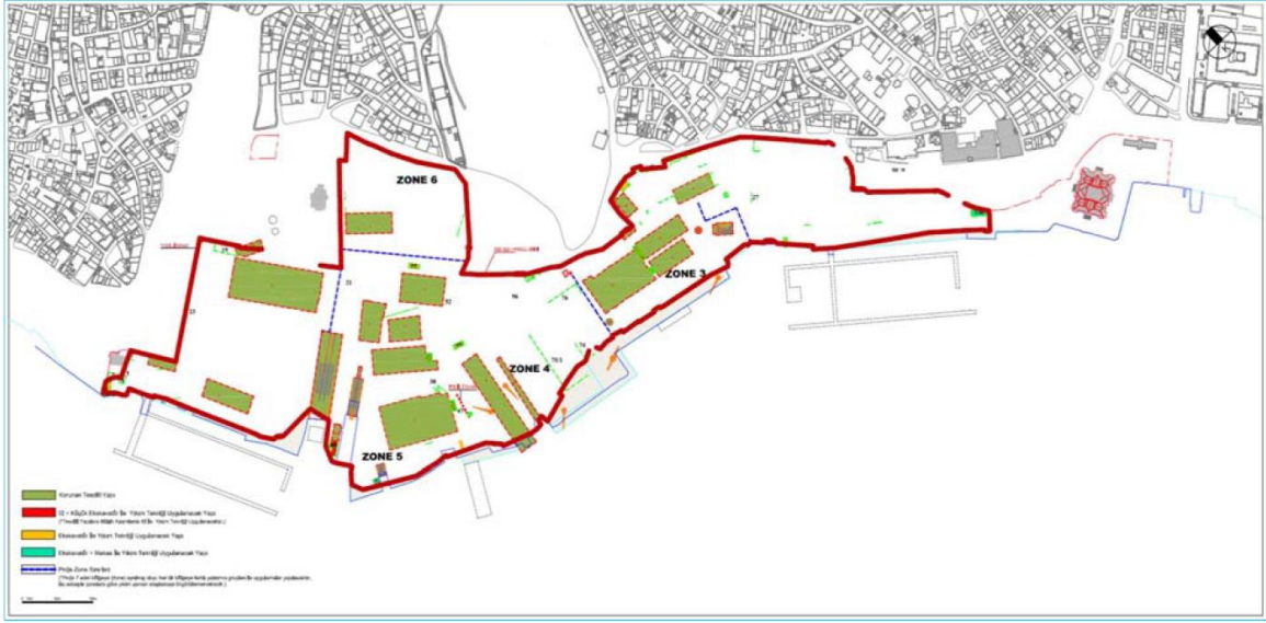
Şekil 4.16. Tersanede ikinci asbest söküm alanı paftası.
