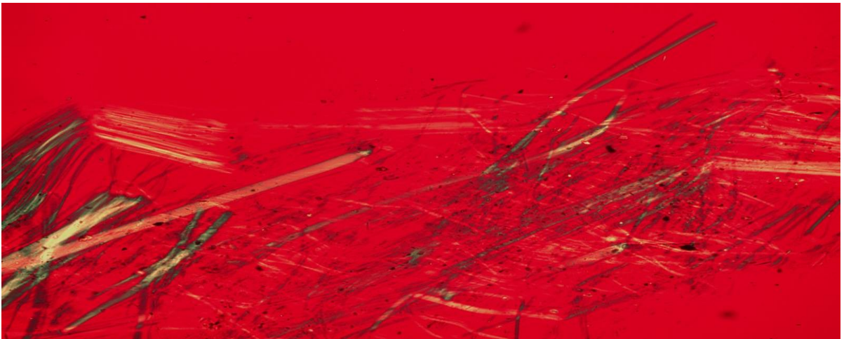
Şekil 5.36. Asbestli (krizotil) eternit malzemenin PLM ekranı görüntüsü.
