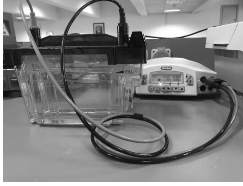
Şekil 3.7. Elektroforez hücresi ve güç kaynağı.
