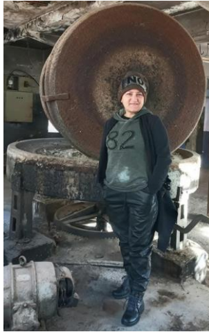
Görsel 128: Tarihi Bilek – İş zeytinyağı fabrikasında zeytin ezilen tarihi taş.
