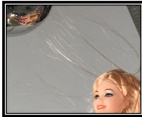
Şekil 6. Pozitif ve negatif yükün oluşturduğu elektrik alanın bebeğin saçlarına etkisi.
