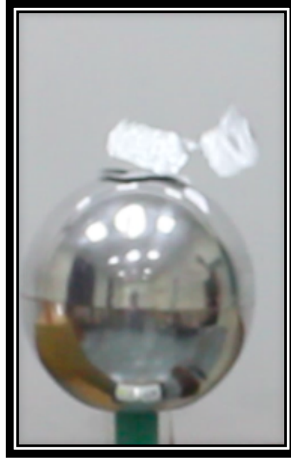
Şekil 7. Elektrik alanın temas durumundaki nötr iletken alüminyum folyolara etkisi.
