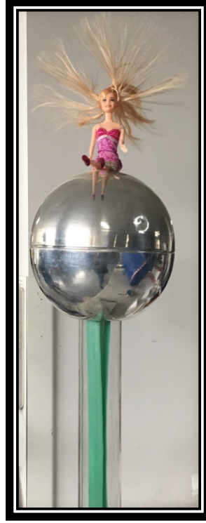
Şekil 4. Elektrik alanın temas durumundaki nötr yalıtkan bebeğe etkisi.
