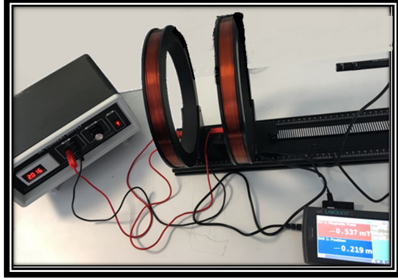
Şekil 29. Bobinlerden aynı yönlü akım aktığında birinci bobinin dışında oluşan manyetik alan durumu ( I:2.0 A, B:-0.53 mT, r_x:-0.21 m).
