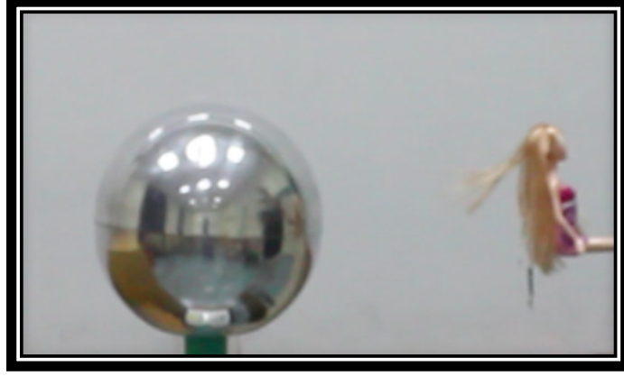
Şekil 5. Elektrik alanın yakınındaki nötr yalıtkan bebeğe etkisi.
