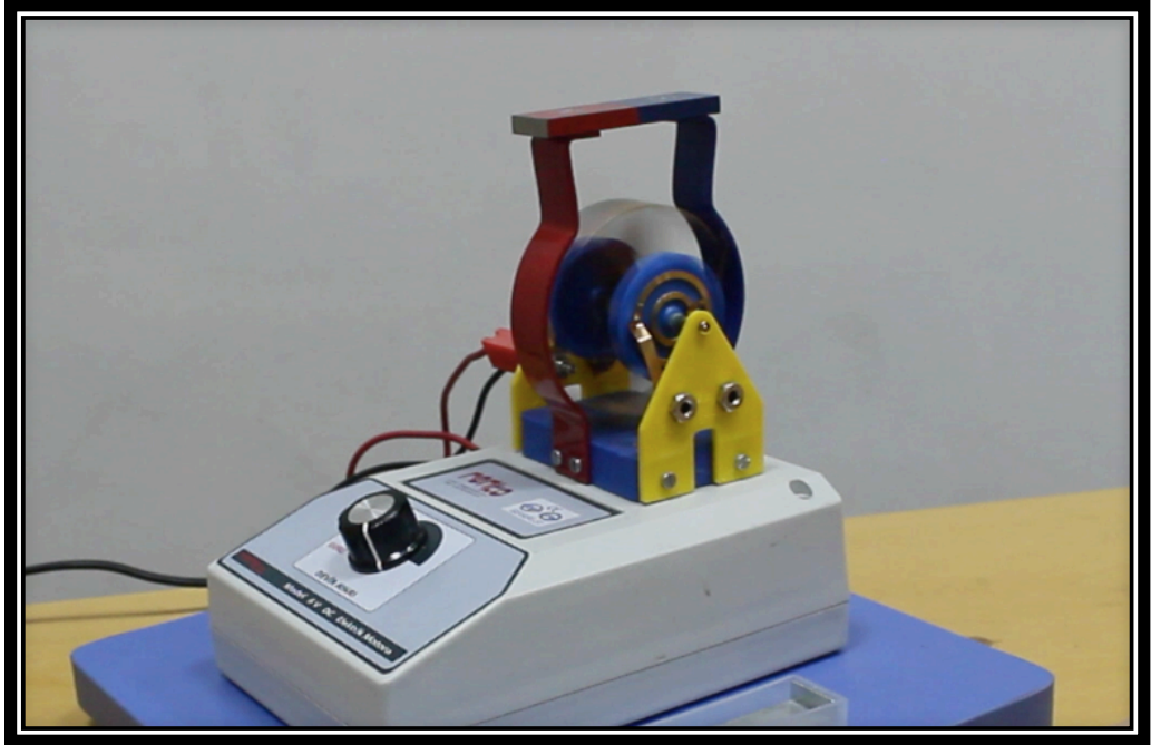
Şekil 40. Dış manyetik alandaki akım ilmeğinin dönme durumu.
