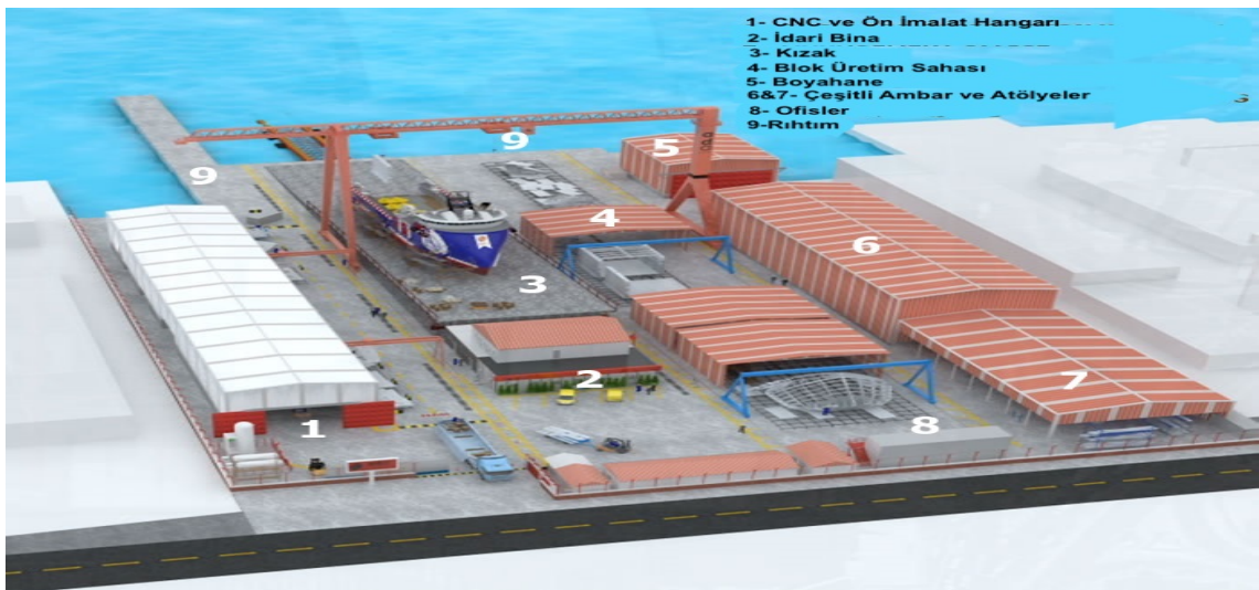
Şekil 2.4 Tersaneyi oluşturan temel birimler
