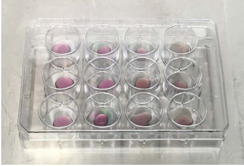
Şekil 3.4. 12 kuyucuklu plaklar içinde bulunan titanyum yüzeyler üzerinde droplet şeklinde hücre kültürü.
