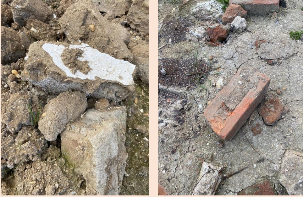
Görsel 29. Yıkım Sonrası Teknik Saha İncelemesi (9 Şubat 2023) ve Her İki Evin Yapısal Kalıntıları. Fakirhaneye Ait Kerpiç (solda); Yukarıki Eve Ait Harman Tuğlası (Sağda), Kişisel Arşiv.
