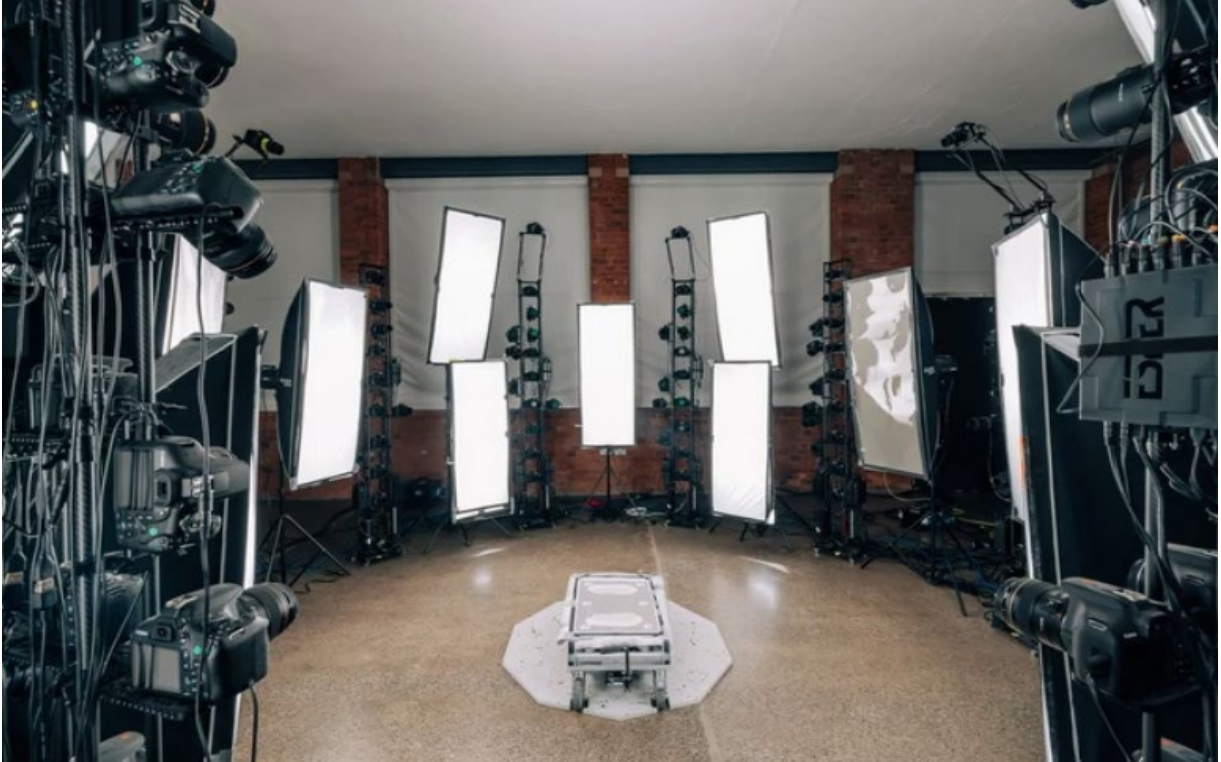
Görsel 43. Fotogrametri teçhizatı. 158 adet fotoğraf makinasından oluşan fotogrametri teçhizatı. Canon Türkiye. https://www.canon.com.tr/pro/stories/3d-photogrammetry/ Erişim: 07.07.2023.
