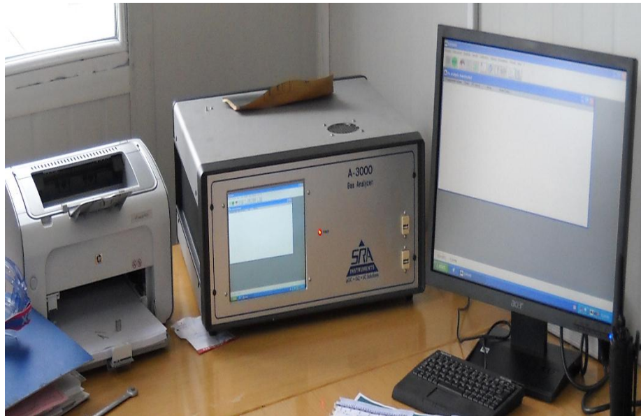
Şekil 4.2. SRA A-3000 Micro GC cihazı
