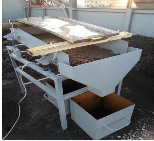
Şekil 3.1. Kömür Eleme Sistemi
