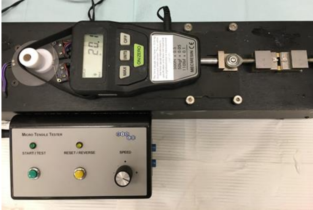
Şekil 3.10. Bağlanma dayanımı testlerinin uygulanması
