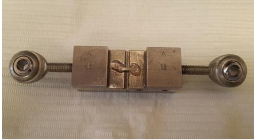
Şekil 3.9. Örneklerin test bloğuna yapıştırılması
