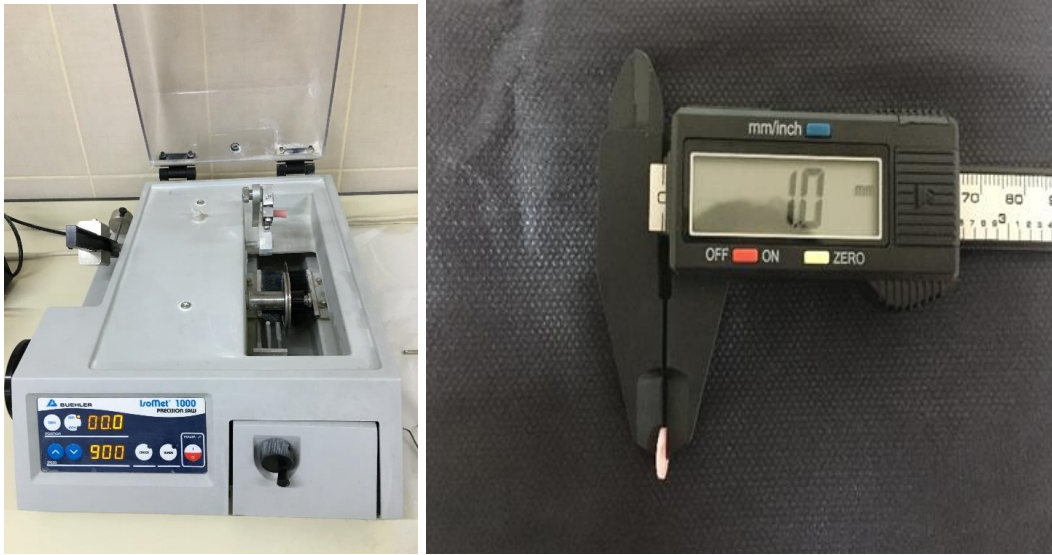
Şekil 3.3.-3.4. Kesitlerin Elde Edilmesi ve Kesit Kalınlıklarının Kontrolü
