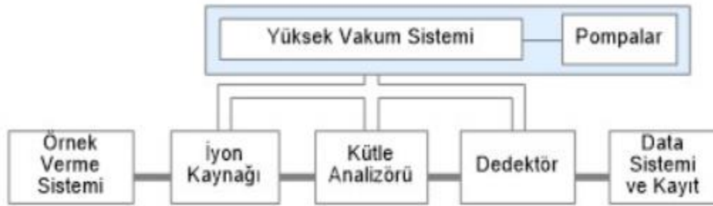
Şekil 3. Bir kütle spektrometresinin temel kısımları [32].
