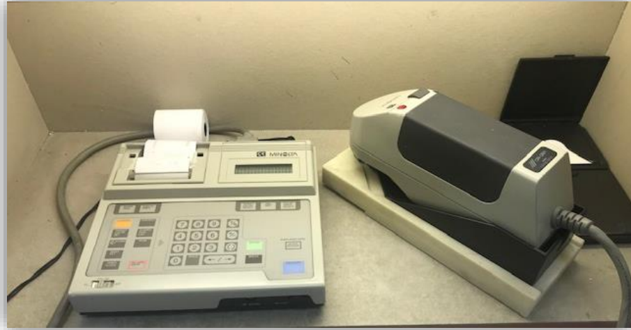
Şekil 3.15. Örneklerin renk ve translusensi ölçümlerinde kullanılan renk ölçüm cihazı, Konica Minolta CR-321 (Minolta, Tokyo, Japan).
