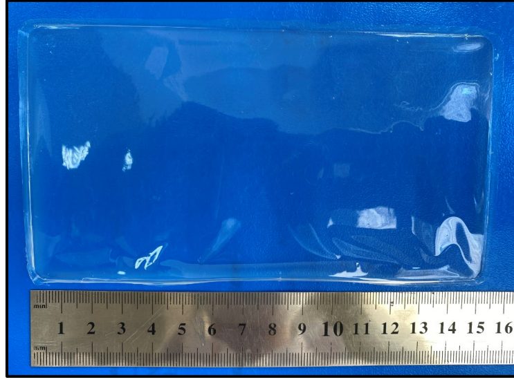
Şekil 3.7. Çubuk ve eliptik disk şeklindeki nanopartiküllerin üretiminde kullanılmak üzere hazırlanan küresel nanopartikül yüklü PVA film.
