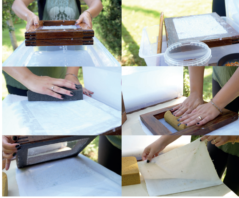
Görsel 51. Kâğıdın süzülme ve transfer aşaması
