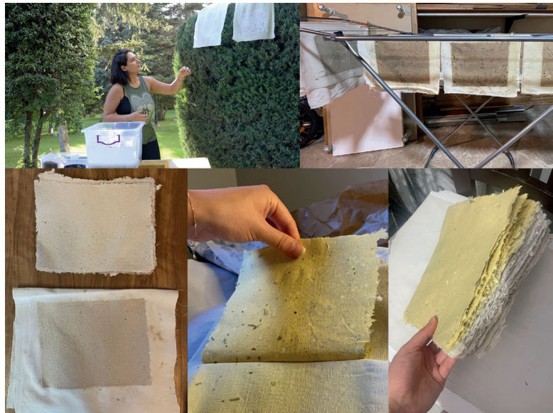
Görsel 52. Kâğıdın kurutulma ve kumaştan ayrılma aşaması.
