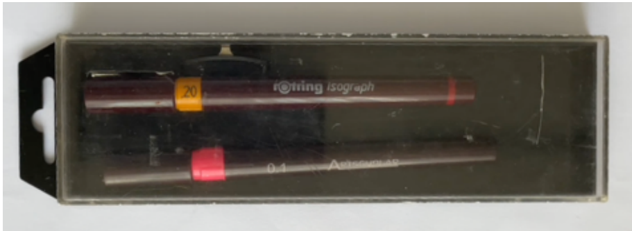
Görsel 56. (Osman Aydoğan'ın teknik çizim koleksiyonundan 1972-1975 yılları arasında üç sene boyunca Eskişehir-Konya yolunu çizerken kullandığı Artscholar Rapidograph ve Rotring Isograph kalemleri)
