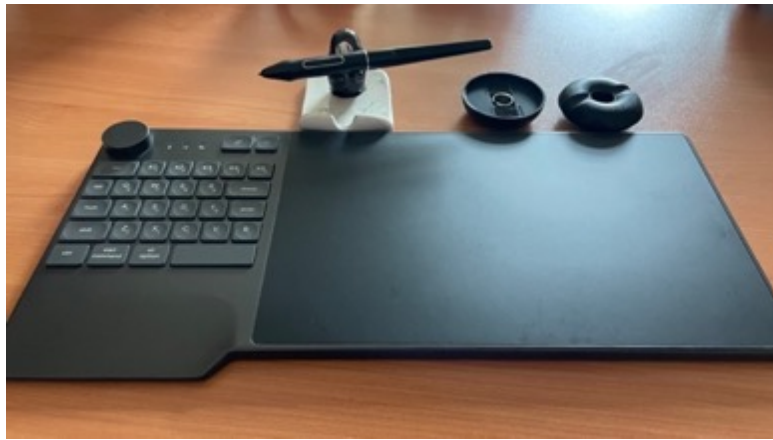
Görsel 37. (Huion Inspiroy Keydial KD200, klavyeli, BT 5.0 bağlantısına sahip tek tablettir. Şarj gerektirmeyen yüksek basınçlı kalem ve yedek uçları yanında gelir. 2021 Fi Design Award kazanmıştır)
