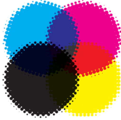
Görsel 117. (CMYK renklerini ve üstüste gelmelerini gösterir.)
