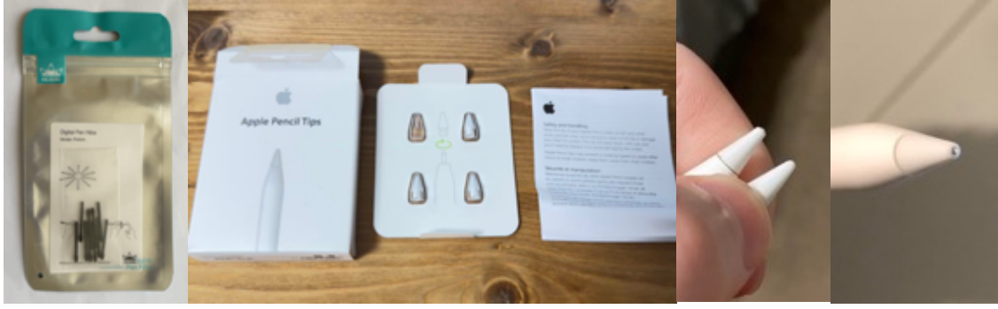
Görsel 39. (Ucu aşınan tablet kalemlerinin yedekleri pakette gelmekle birlikte gerektiğinde ayrıca alınıp kolayca değiştirilebilmektedir. Ucu aşındığı kalem hareketinin pürüzlülüğünü yitirmesinden anlaşılmaktadır, değiştirilmekte geç kalınırsa tabletin çizim alanına veya varsa ekranına zarar gelebilir.)
