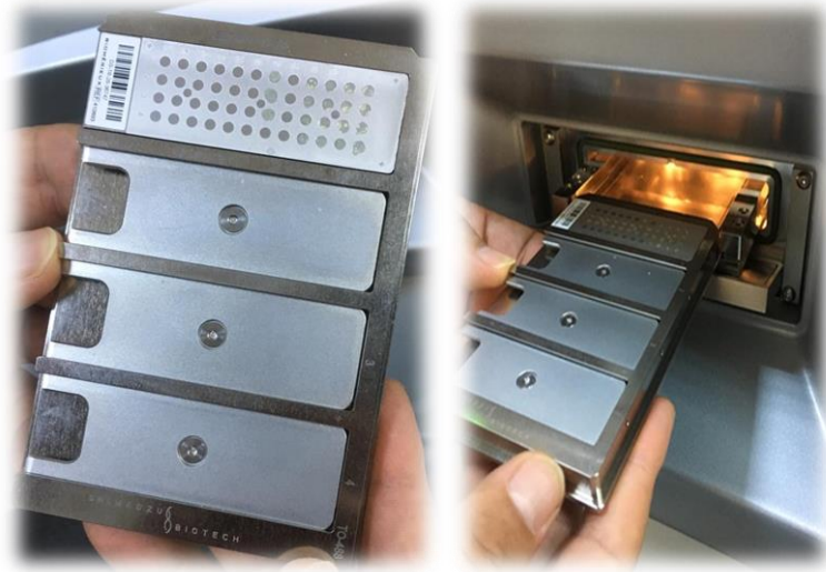
Şekil 3.4. MALDI-TOF MS plakası ve mikroorganizmaların cihaza yüklenmesi.
