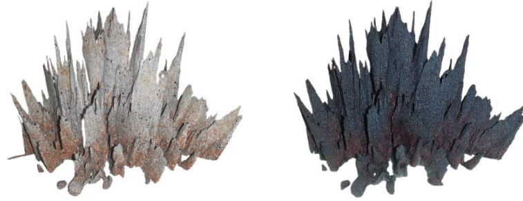
Görsel 79. C-M50-A numunesinin bisküvi (solda) ve sır pişirimi (sağda) sonrası görünümleri. (Kişisel Arşiv).
