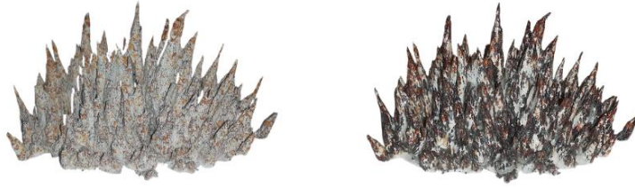
Görsel 70. B75-A numunesinin (%75 su) bisküvi (solda) ve sır pişirimi (sağda) sonrası görünüşleri. (Kişisel Arşiv).
