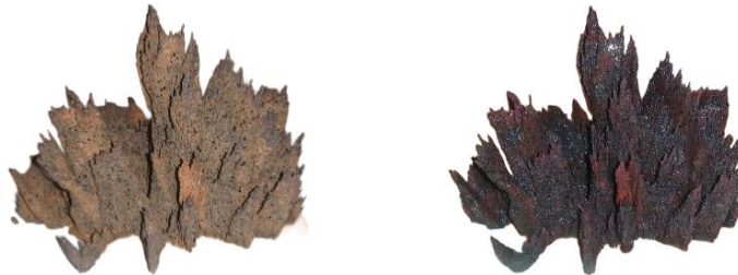
Görsel 77. C25-A-Menemen numunesinin bisküvi (solda) ve sır pişirimi (sağda) sonrası görünümüleri. (Kişisel Arşiv).
