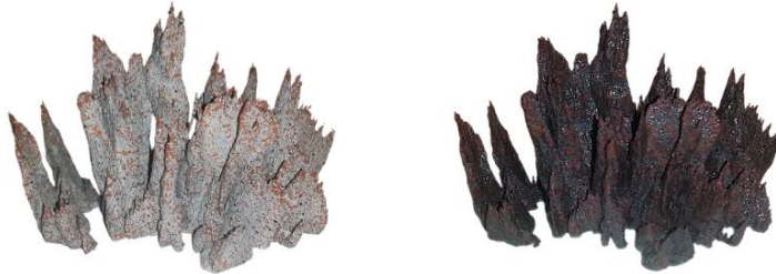
Görsel 71. C35-A numunesinin bisküvi (solda) ve sır pişirimi (sağda) sonrası görünüşleri. (Kişisel Arşiv).
