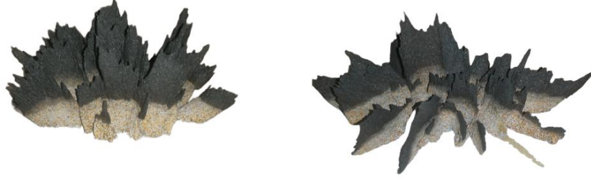
Görsel 65: C-M35 numunesinin (pişirim öncesi) farklı manyetik alan konfigürasyonlarındaki şekillenme görünümleri; solda zıt kutuplar (N-S), sağda aynı kutuplar (N-N). (Kişisel Arşiv).
