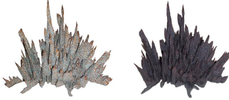
Görsel 72. C50-A numunesinin bisküvi (solda) ve sır pişirimi (sağda) sonrası görünüşleri. (Kişisel Arşiv).
