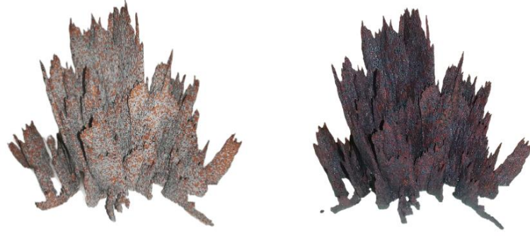
Görsel 85. C-CMC050-A numunesinin bisküvi (solda) ve sır pişirimi (sağda) sonrası görünüşleri. (Kişisel Arşiv).
