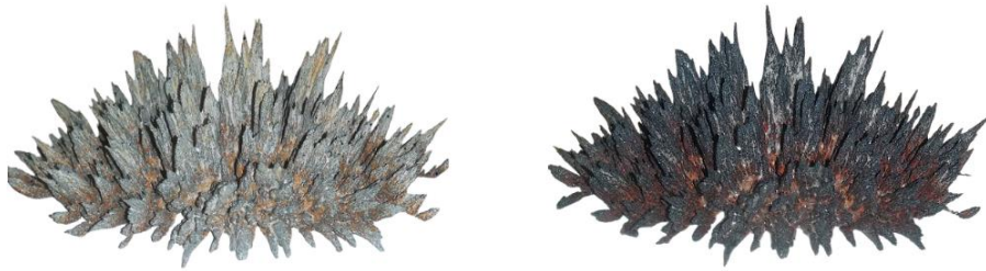
Görsel 80. C-M75-A numunesinin bisküvi (solda) ve sır pişirimi (sağda) sonrası görünümleri. (Kişisel Arşiv).
