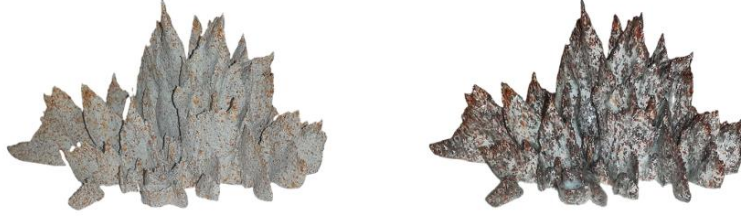
Görsel 69. B50-A numunesinin bisküvi (solda) ve sır pişirimi (sağda) sonrası görünüşleri. (Kişisel Arşiv).
