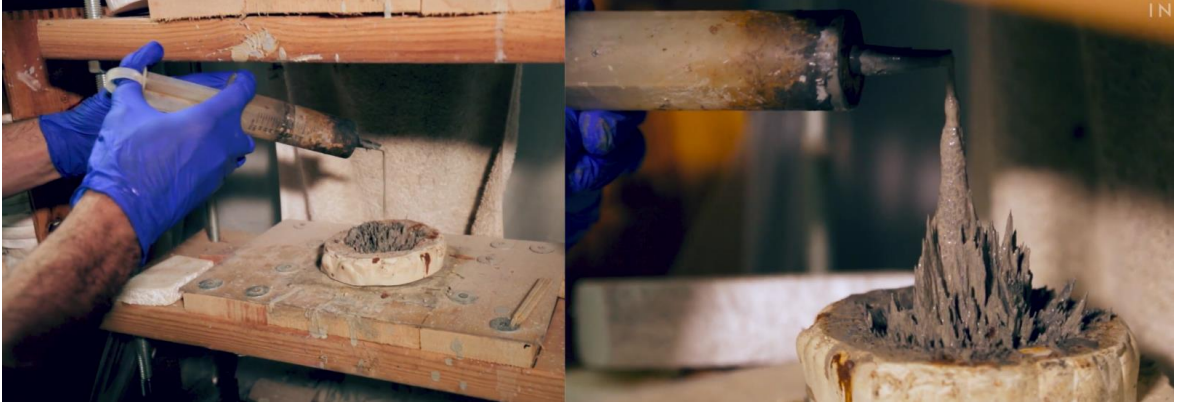
Görsel 47. Sabri Ben-Achour. Karışımın bir kalıp içine şırıngayla ekstrüze edilme anı. (YouTube). https://shortlink.uk/1vHyV
