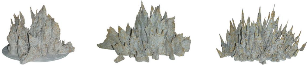
Görsel 57. Soldan sağa doğru B40-A, B50-A ve B75-A numunelerinin pişirim öncesi görünüşleri. (Kişisel Arşiv).
