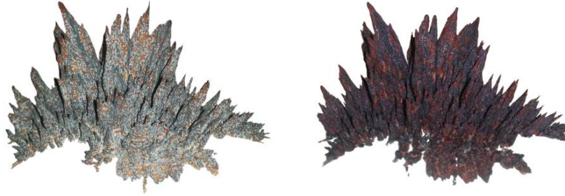
Görsel 73. C75-A numunesinin bisküvi (solda) ve sır pişirimi (sağda) sonrası görünüşleri. (Kişisel Arşiv).
