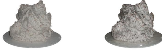
Görsel 66. A50-A numunesinin bisküvi (solda) ve sır pişirimi (sağda) sonrası görünüşleri. (Kişisel Arşiv).
