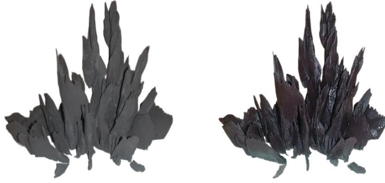
Görsel 75. C50-C numunesinin bisküvi (solda) ve sır pişirimi (sağda) sonrası görünümüleri. (Kişisel Arşiv).3).
