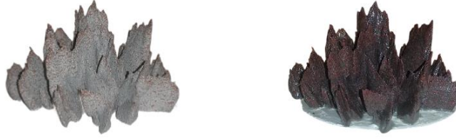
Görsel 76. C30-A2 numunesinin bisküvi (solda) ve sır pişirimi (sağda) sonrası görünümüleri. (Kişisel Arşiv).
