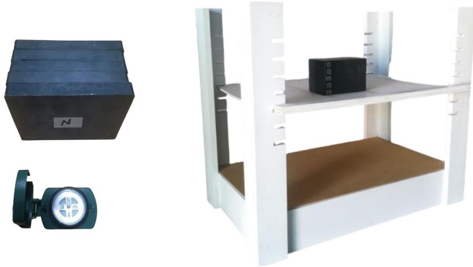
Görsel 52. Solda mıknatıs kutuplarının pusula yardımıyla belirlenmesi, sağda mıknatısların zıt kutuplar halinde düzeneğe yerleştirilmiş hali. (Kişisel Arşiv).
