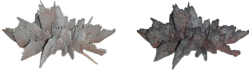
Görsel 87. C-M35-A numunesinin bisküvi (solda) ve sır pişirimi (sağda) sonrası görünüşleri; aynı kutup (N-N) konfigürasyonu. (Kişisel Arşiv).
