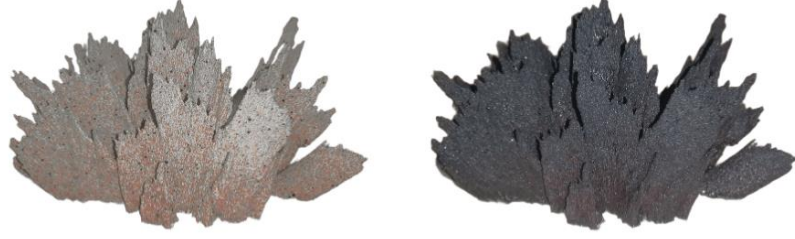
Görsel 78. C-M35-A numunesinin bisküvi (solda) ve sır pişirimi (sağda) sonrası görünümleri. (Kişisel Arşiv).
