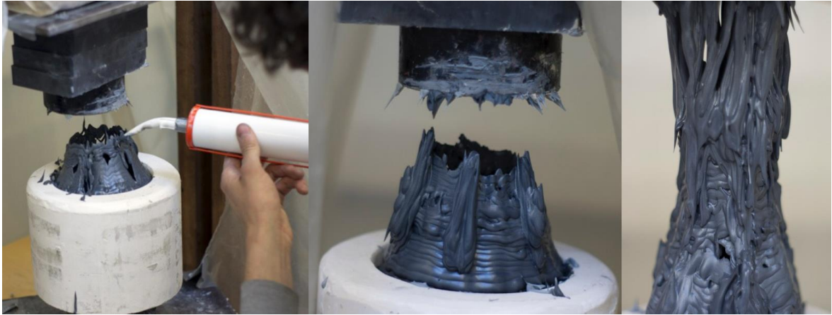
Görsel 43. Jolan van der Wiel. Dragonstone üretim süreci, (kompozit malzemenin şırınga ile ekstrüzyon anı). (Dezeen / Core77). https://goo.su/CyK9NU ; https://goo.su/NXuzUt
