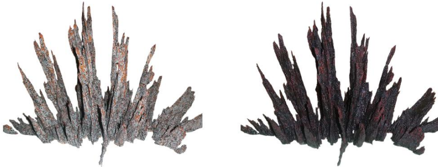
Görsel 74. C30-B numunesinin bisküvi (solda) ve sır pişirimi (sağda) sonrası görünüşleri. (Kişisel Arşiv).
