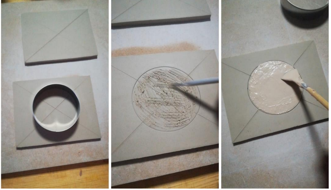
Görsel 53. Karışımların uygulanacağı çamur plakasının hazırlanış aşaması. (Kişisel Arşiv).
