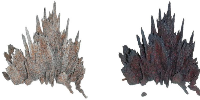
Görsel 82. C-SM17,5-A numunesinin bisküvi (solda) ve sır pişirimi (sağda) sonrası görünüşleri. (Kişisel Arşiv).
