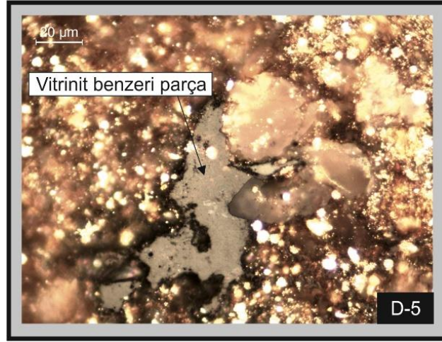
Şekil 7. 2. D-5 numaralı örnekte gözlenen vitrinit benzeri parçanın optik mikroskop görüntüsü (yağlı 50x objektif).
