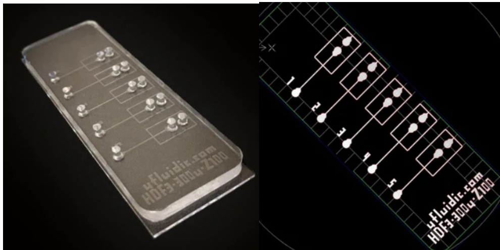
Şekil 3.2. Mikroakışkan karıştırma yönteminde kullanılan çipin yapısını gösteren modellere ilişkin örnek fotoğraflar (uFluidic).
