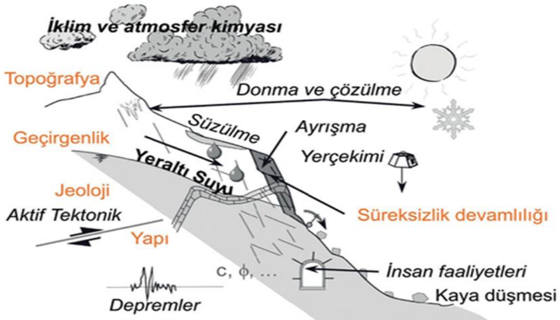
Şekil 3-2. Kaya düşmelerine neden olan iç ve dış faktörler (Volkwein vd., 2011; AFAD, 2020)
