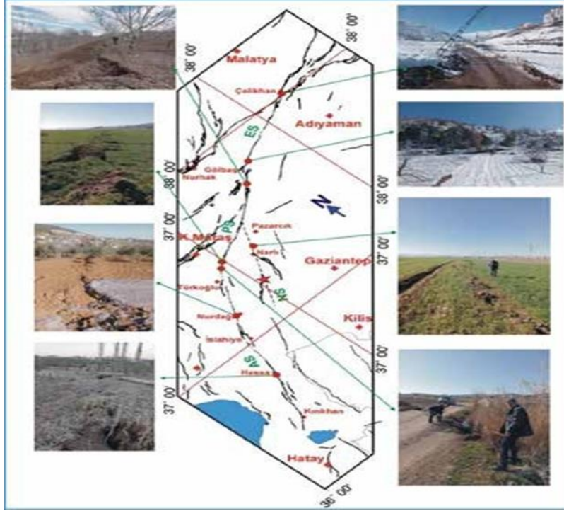
Şekil 4-2. 6 Şubat 2023 Pazarcık depremi saha çalışmalarında gözlenen yüzey kırıkları (MTA, 2023)
