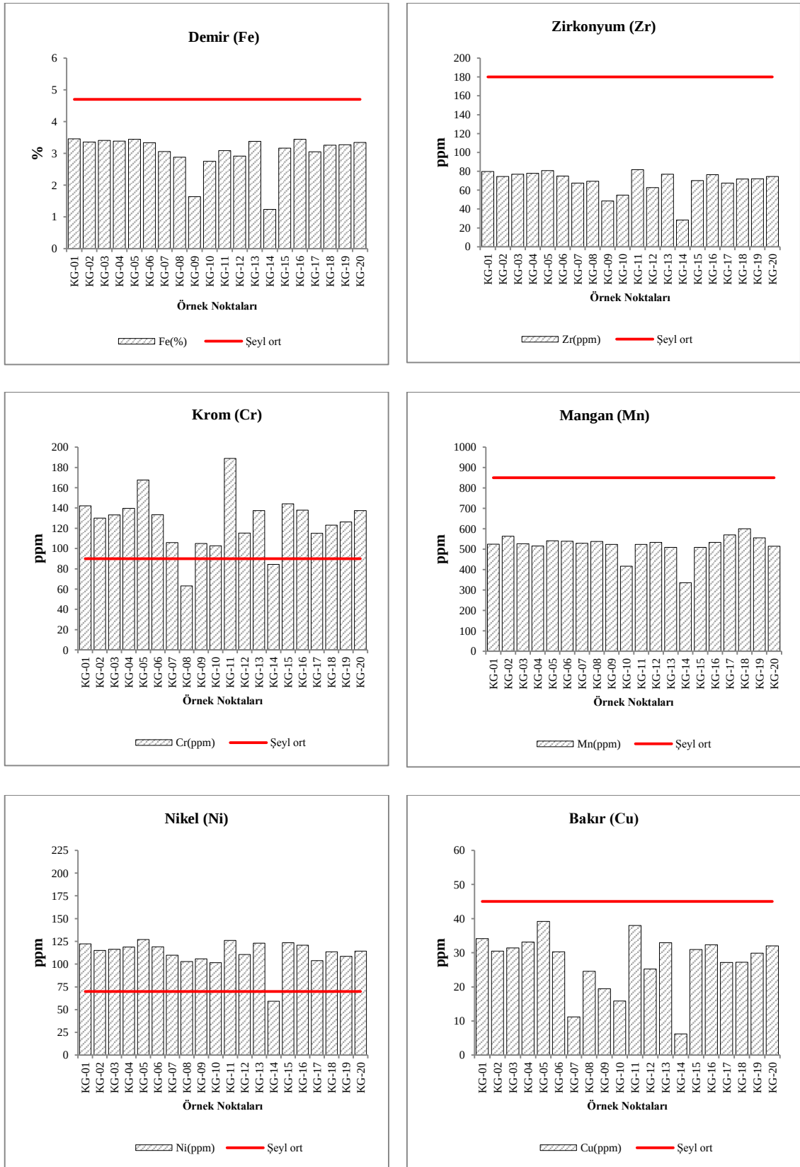
Şekil 4.21. Çalışma alanı yüzey örnekleri multi-element dağılımlarının şeyl ortalamaları ile karşılaştırılması (Yatay çizgi şeyl ortalama değerini temsil etmektedir)
