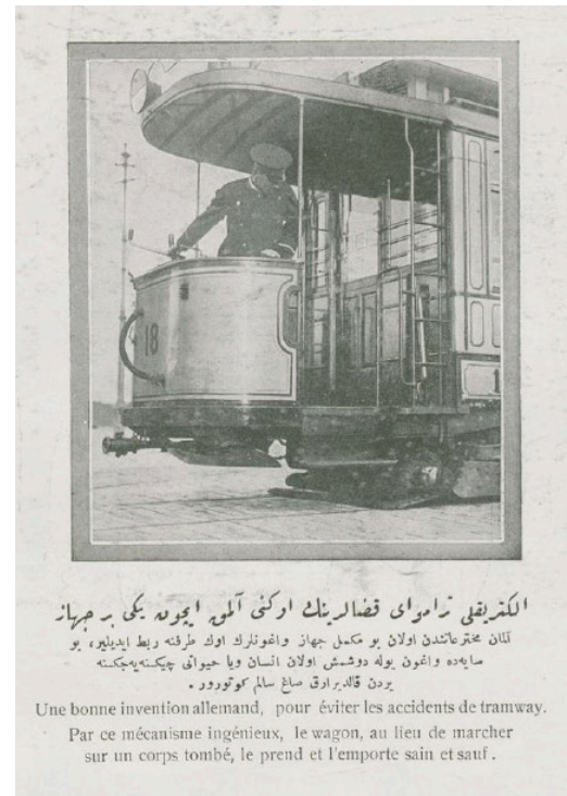
Fotoğraf 79. Elektrikli tramvay kazalarını önlemek için yeni bir cihaz. Alman bir üretici tarafından yapılan bu mükemmel cihaz, vagonların ön tarafına takılıyor; böylece vagon yola düşen bir insanı veya hayvanı çiğnemek yerine alıyor ve güvenli bir şekilde uzaklaştırıyor. 1 Ağustos 1326 (1910) 1/24
