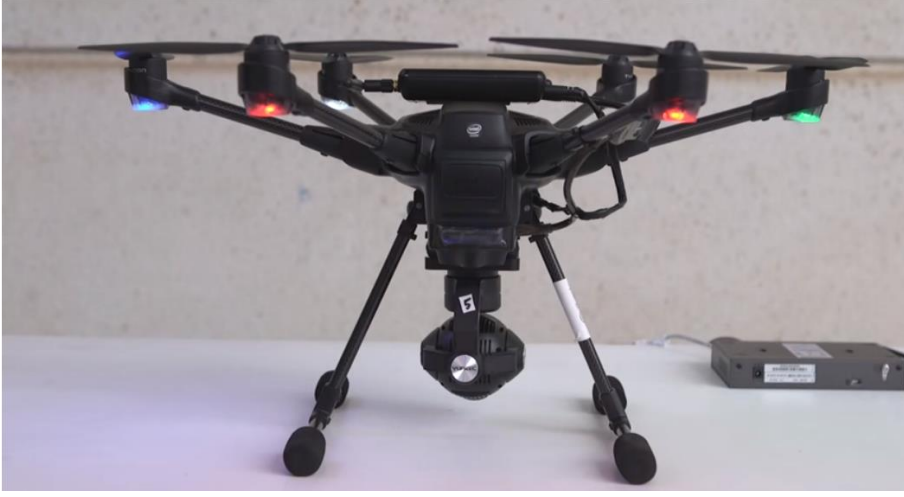
Şekil 1.3. AT&T Mobile ve Intel'in İHA Baz İstasyonu Prototipi [9]
