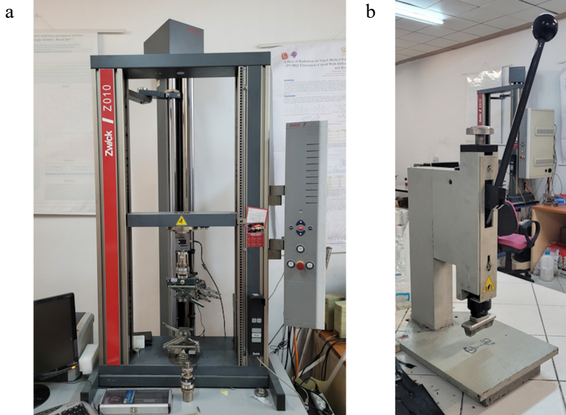
Şekil 3.9. (a) Zwick Z010 evrensel test cihazı ve (b) ZC020 test parçaları kesme aleti
