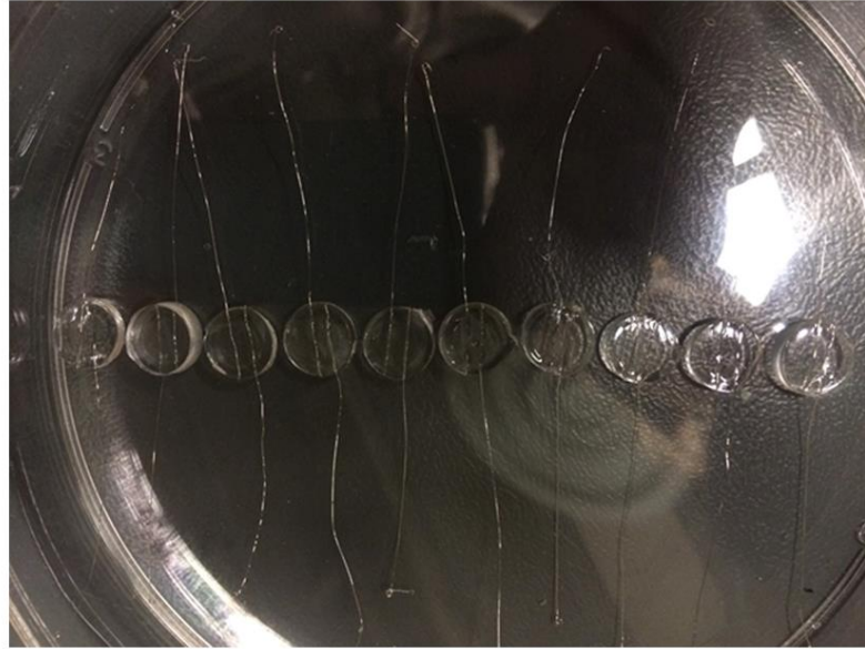
Şekil 4.4. Elektrostimülasyon çalışmalarında kullanılmak üzere üretilen, platin tel içeren ipek filmlerin genel görüntüleri.
