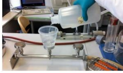
Şekil 3.18. Laboratuvar’da uygulanan membran filtrasyon mekanizması.
