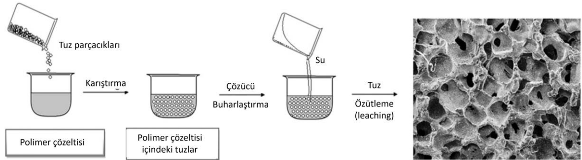
Şekil 2.5. Çözücü-döküm/partikül-uzaklaştırma tekniğinin şematik gösterimi ([46]'dan değiştirilerek).
