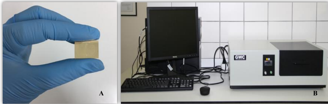
Şekil 3.3. SPR biyosensörün altın yüzeyi (A) ve SPRImager®II sistemi (B).
