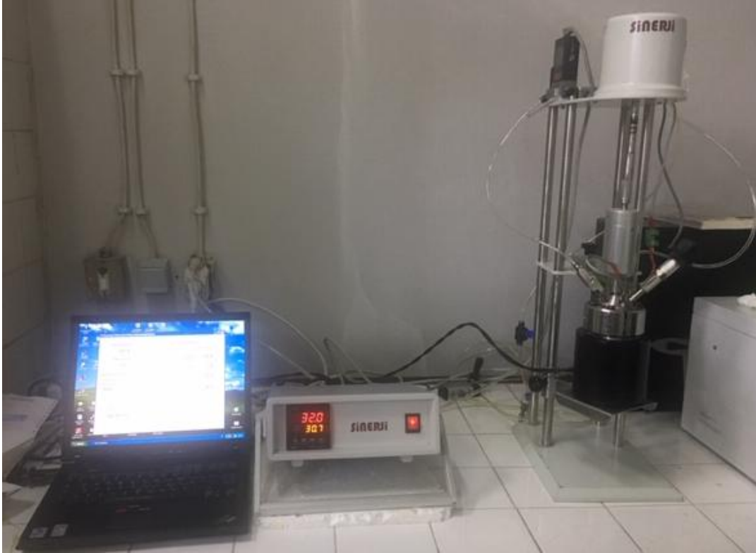
Şekil 3. 1.Gaz-sıvı temas sisteminin absorpsiyon işlemi sırasındaki görünümü
