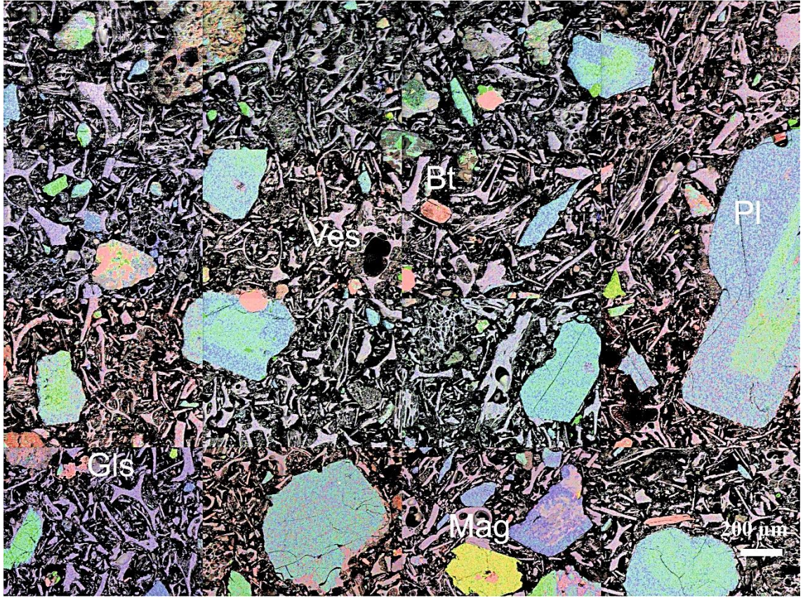
Şekil 2.5. Büyük harita, EDS analizleri sonucu oluşturulan eş ölçekli haritaların birleştirilmesi ile elde edilmiş ve bu büyük haritadan kayacın jüvenil cam, kristal ve gözenek içeriği hesaplanmıştır.
