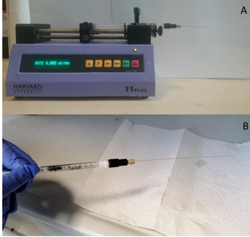
Şekil 3.2. (A) Silanlama işlemi için kurulan düzenek (B) MSA bağlı-poli(POSS-MA) kapiler monolitlerin hazırlanması
