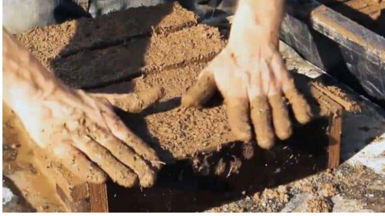
Görsel 6. Tahta kalıplara dökülerek güneşte kurutulmaya bırakılan saman ve su karışımı tuğla veya kerpiç, Erişim: 21.07.2019. https://www.muhendisbeyinler.net/kerpic-nedir/
