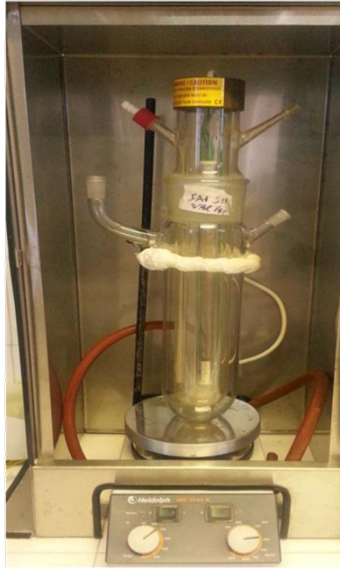
Şekil 3.3. UV – reaktörü ve şematik görünümü [127].
