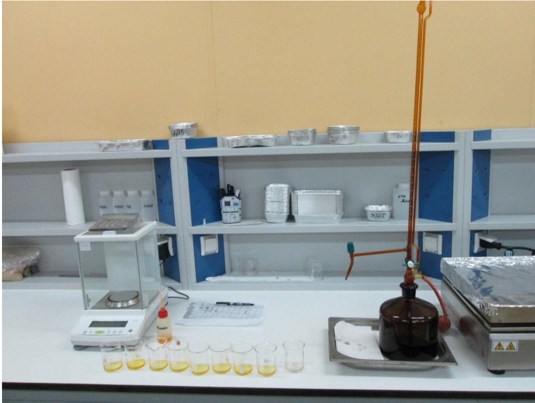
Şekil 3.6 Gümüş nitrat titrasyonu yöntemi ile serbest siyanür ölçüm düzeneği
