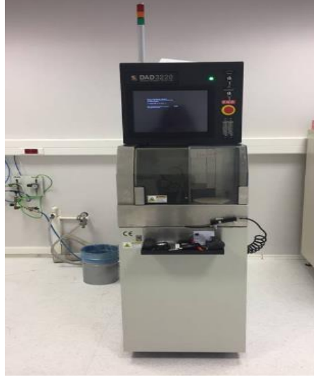
Şekil 3.7. DAD3220 (Disco Automatic Dicing) Sistemi
