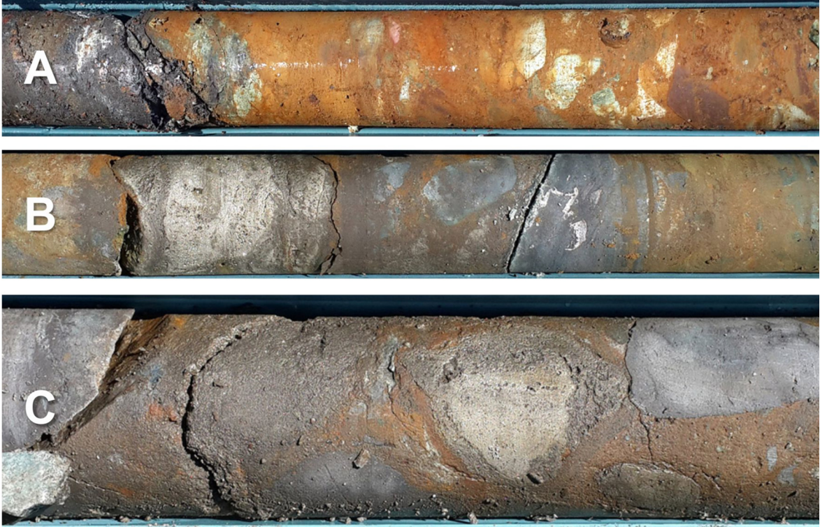
Şekil 2.24. A: MD-33 sondajında tamamen oksitlenmiş breşik cevher. B: MD-11 sondajında çoęunlukla oksitlenmiş-az oranda korunmuş cevher (yaklaşık 10 cm'lik korunmuş masif cevher). C: MD-11 sondajında kısmen oksitlenmiş-kısmen korunmuş cevher. (A için karot çapı: 6,35 cm, B ve C için karot çapı: 8,5 cm)
