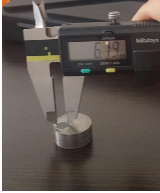
Şekil 5-9. İş parçası ve takım ucu aralığının 0,30 mm olduğu durumda ~6 mm olması gereken işleme alanı çapı
