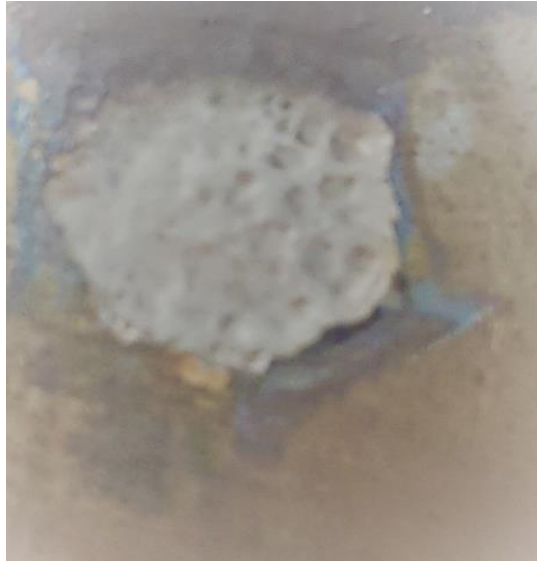
Şekil 5-12. pH 3,5 değerinde işlenen Ti6Al4V alaşımı görüntüsü (x2.5 optik büyütme)
