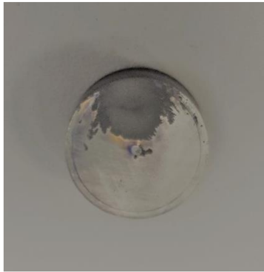
Şekil 5-11. 50 °C elektrolit sıcaklığı ile elde edilen Ti6Al4V işleme
