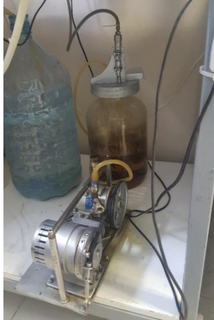
Şekil 4-6. Vakum pompası ve kirli elektrolit toplama sistemi
