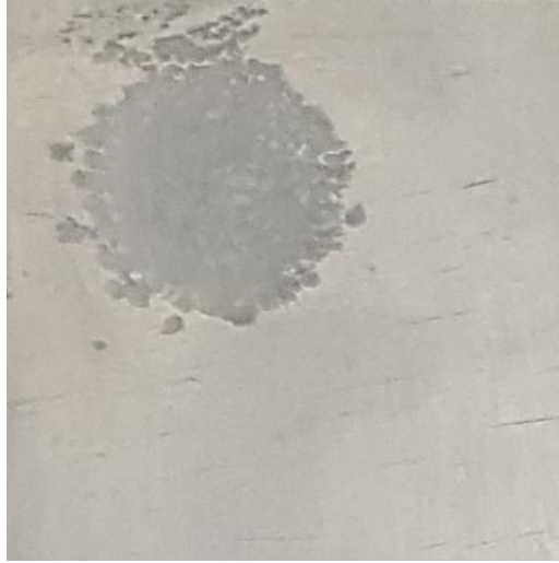
Şekil 5-16. Ton > Toff değerinde işleme sırasında elde edilen iş parçası
