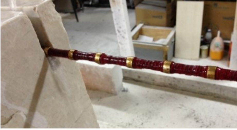
Şekil 3.6. Kesim işleminde kullanılan elmas telden bir görüntü
