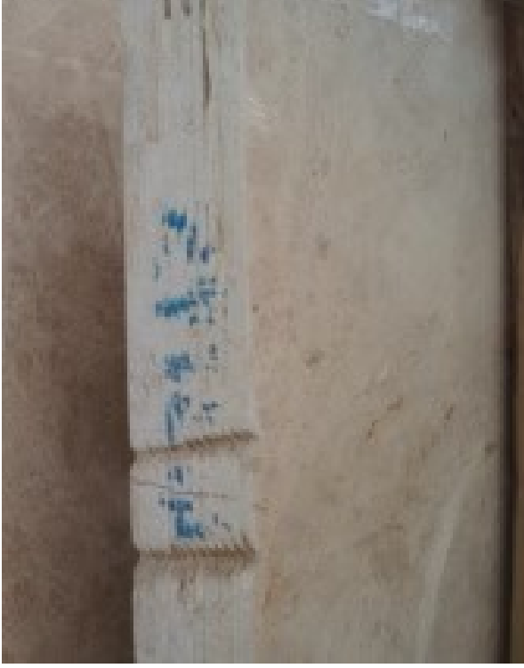
Şekil 2.7. Üretilen plakada testere izleri [39]
