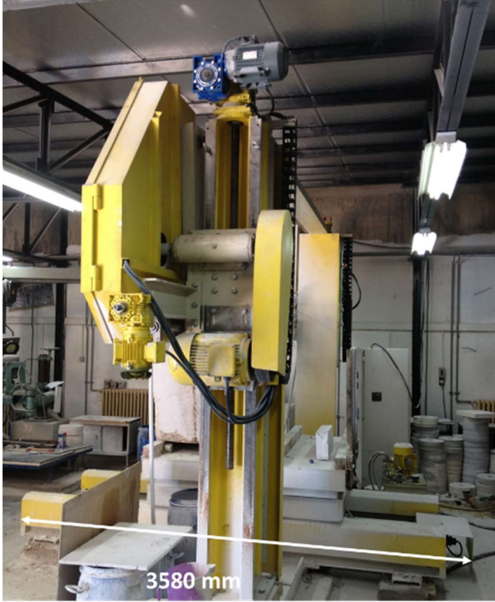
Şekil 3.3. Bilgisayar kontrollü tektelli kesim makinesinin boyutları [3]
