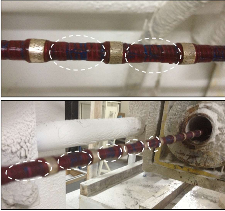
Şekil 3.11. Sprey boya kullanılarak işaretlenen boncuklar [3]
