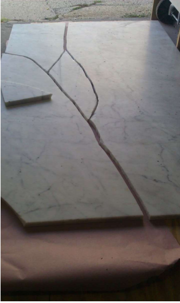
Şekil 2.9. Üretimi esnasında kırılan plaka [40]
