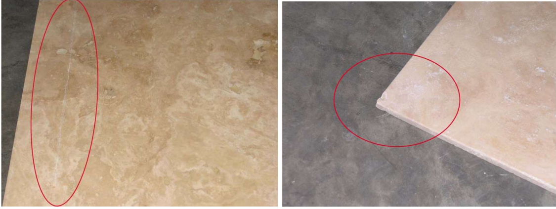
Şekil 2.8. Üretimi esnasında taş yüzeyinde oluşan çizik ve kırıklar [38]
