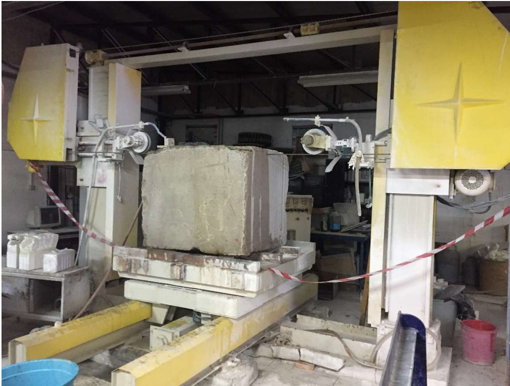
Şekil 3.2. Çalışmada kullanılan tektelli kesme makinesinin genel görünümü
