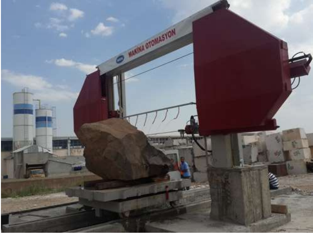
řekil 1.1. Dođal tař ocaklarında kullanılan tektelli kesme makinesi [2]
