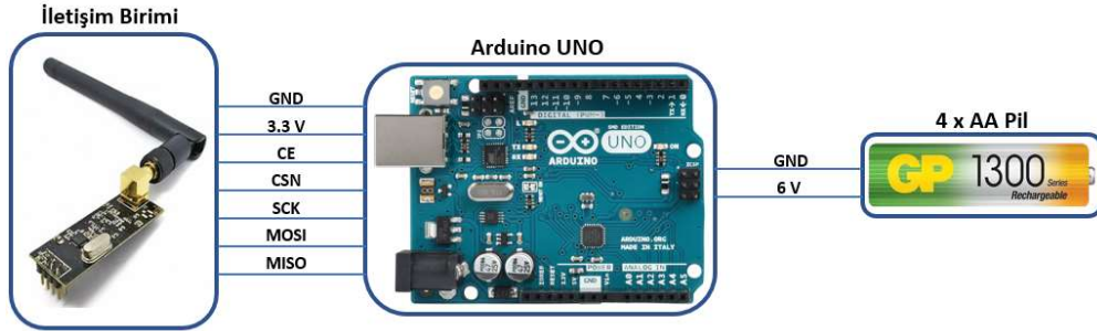
Şekil 3.11. KSA Diğer İstasyonların Yapısı.
