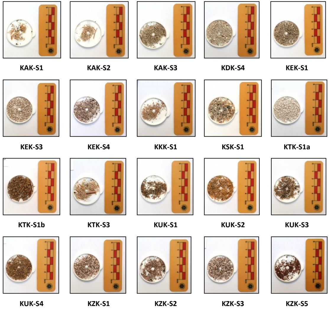
Şekil 4. Ihlara Vadisi Bizans dönemi kiliseleri sıva örneklerinin agregaları
