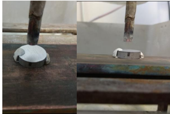
Şekil 3. 5 İş parçasının elektrokimyasal işleme tezgahına yerleştirilmesi
