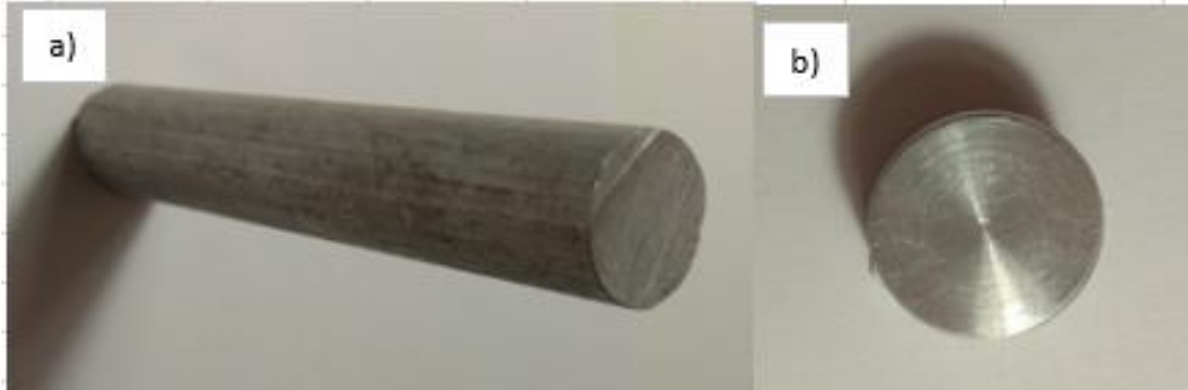
Şekil 3. 1 a) 1,6 cm çapta, 10 cm uzunlukta silindir boru şeklinde Al-6061 alaşımı, b) 1,5 cm çapta, 2 cm yüksekliğinde kesilmiş Al-6061 malzemesi
