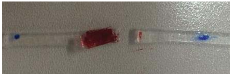
Şekil 4.29. PDMA hidrojelinin örtüşme alanı dışında kopması
