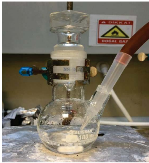
Şekil 3.2. PDMA hidrojel sentezi
