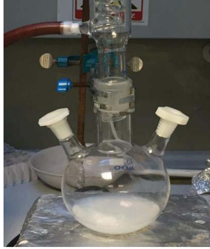
Şekil 3.9. Stöber metodu ile silika nanopartikül sentezi
