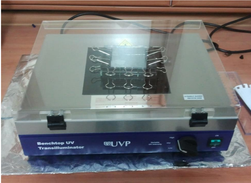
Şekil 3.2. UV-transilluminator (Benchtop UV Transilluminator, UVP)
