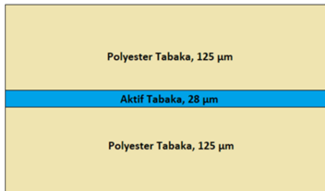
Şekil 2.5. Gafkromik EBT3 film yapısı.
