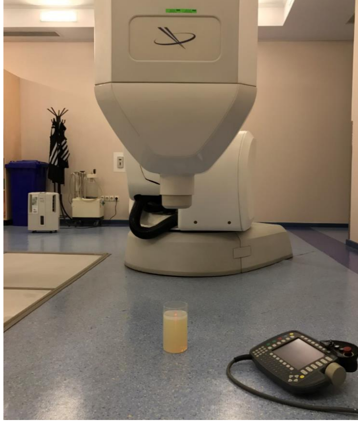
Şekil 3.17. MAGIC polimer jel dozimetre ölçüm düzeneği
