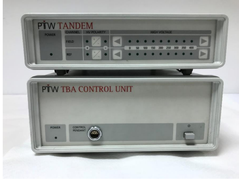
Şekil 3.8. PTW TBA kontrol ünitesi ve PTW TANDEM iki kanallı elektrometre
