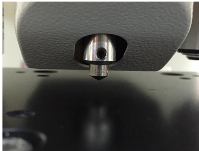
Şekil 3.13. Vickers sertlik cihazı intendörü
