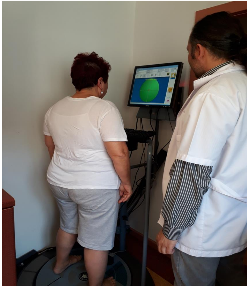
Şekil 3.7. Stabilometre SporKat 2000 – Statik denge ölçümü.
