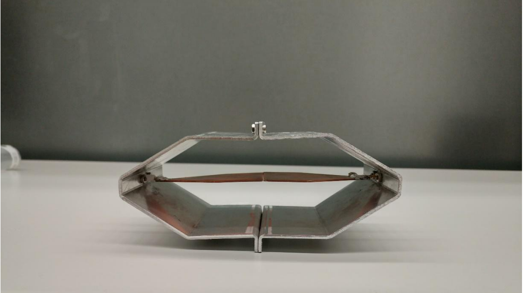
Şekil 4.24 Dikdörtgen Kesit Alanına ve 30 Derece Sivrilme Açısına Sahip TEM-t Hücresi
