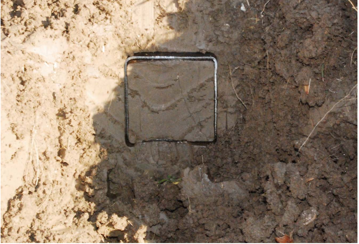
Şekil 7-2 Makaslama kutusuyla örnek alınması
