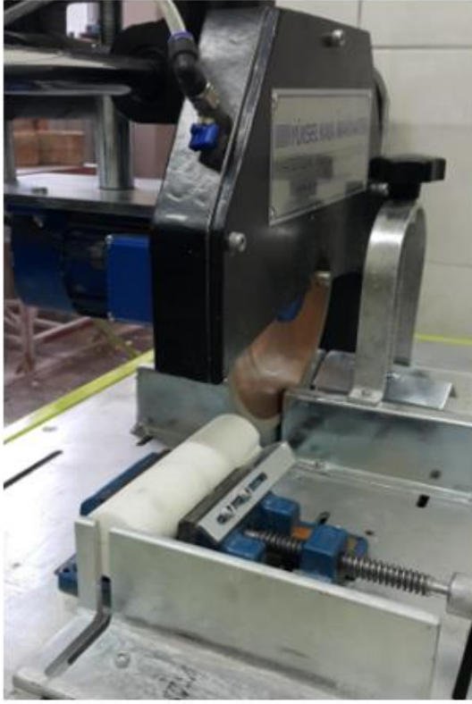
Şekil 4.2. Taş kesme makinesine monte edilmiş mengeneli düzenek.
