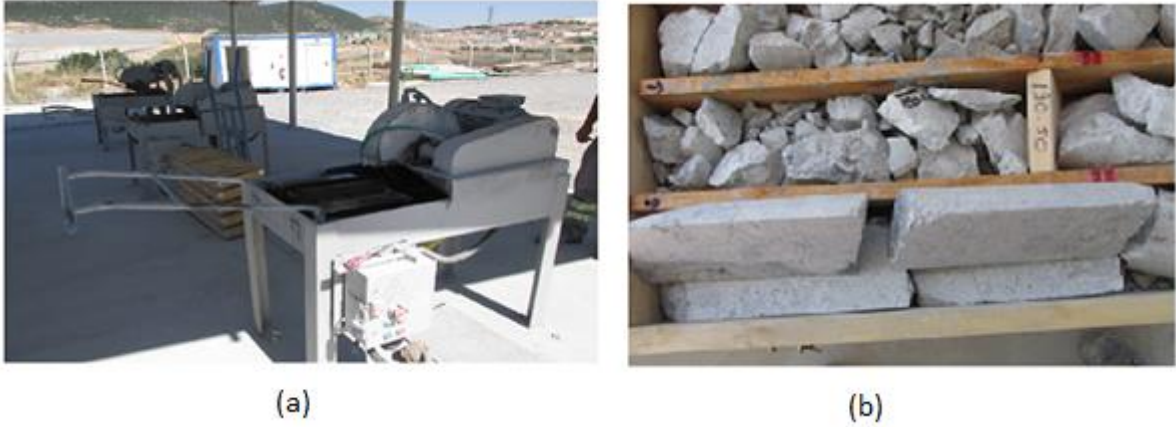
Şekil 1.1. Türkiye'deki bir açık işletmede kullanılan (a) taş kesme ve yarılama makinesinden ve (b) yarılanmış karotlardan birer görünüm (Fotoğraflar: R.Ulusay)
