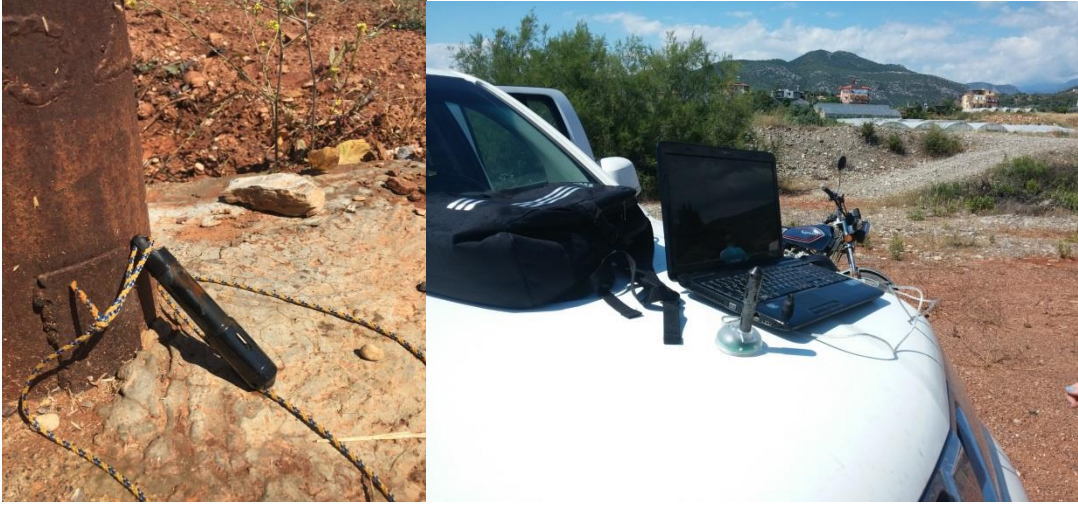
Şekil 3.3. Gözlem yapılan kuyularda yeraltısuyu seviyesi, sıcaklığı ve elektriksel iletkenlik gözlemi için kullanılan veri toplar cihazı (CTD Diver).
